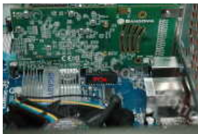
Fig 3. Conectarea placii VoIP in slotul PCIe
