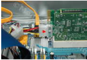
Fig 5. Cuplarea alimentarii pentru placile cu module FXS
