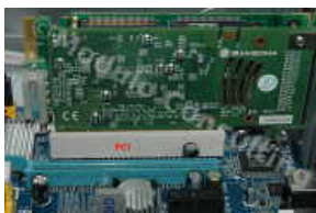
Fig 4. Conectarea placii VoIP in slotul PCI
